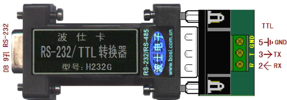
H232G 的 DB-9 针 TTL 引脚分配为（配有接线端子）：2-RX、3-TX、5-GND。
