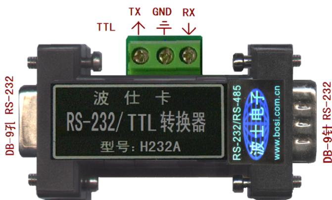
H232G 的外形为 DB-9（孔）/DB-9（针）转接盒大小。DB-9 孔端可以直接外插 PC 机的 RS-232 口。DB-9 针端有接线端子直接接单片机的串行口，引脚分配如图。
