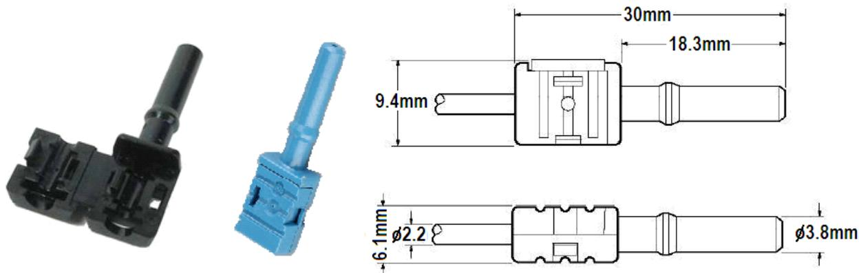
通信用塑料光纤接头，可用于  $\Phi 1/2.2\text{mm}$  通信塑料光纤。接头为单线锁式。所有连接部件可配套使用，达到快速插接效果。单线接头可用不同颜色标记，以便识别发送器和接收器的连接。双线接头采用卡槽定位，保证插入时方位准确。接头材料为阻燃材料。
